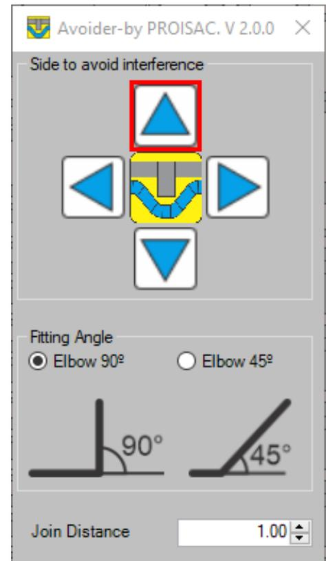
Luego seleccionamos los elementos MEP que queremos que generen sus curvas, para evitar interferencias, y por ultimo le damos a FINISH para que se generen las curvas.
